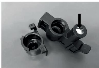
4. Вымойте обе части механизма вспенивания теплой водой с использованием средства для мытья посуды и мягкой неабразивной губки и просушите. Для более тщательной очистки и лучшего результата воспользуйтесь зубочисткой или иглой. Место для чистки иглой показано стрелкой.
