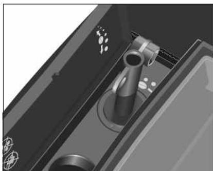
Возможна настройка кофемолки в соответствии со степенью обжарки используемого кофе.
