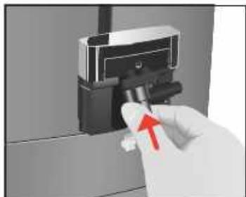
▸ Установите собранные детали обратно в комбинированный дозатор и с нажимом зафиксируйте.
