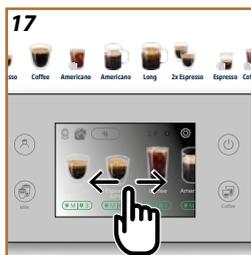
Ваш прибор позволяет готовить самые разнообразные напитки: прокручивайте напитки на дисплее до тех пор, пока не отобразится нужный (рис. 17):
