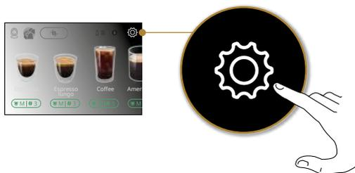
*Прокрутите страницы до отображения пункта «Промывка». Нажмите «Да» для запуска подачи. Через несколько секунд выйдет горячая вода, которая очищает и нагревает внутренние каналы машины.*
