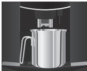
При выключении кофемашины D4 промывка системы выполняется автоматически, если была использована функция приготовления кофейного напитка.
