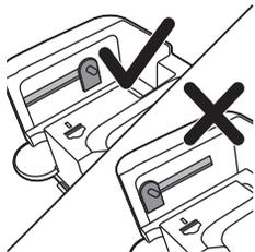
Примечание. Перед тем как установить носик для молочной пены на верхнюю часть сосуда, необходимо установить в нужное положение фиксатор, расположенный в верхней части. Если этот фиксатор расположен неправильно, вы не сможете установить носик для молочной пены на верхней части сосуда.
