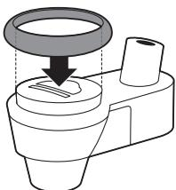
**11** Снова прикрепите автоматический вспениватель молока к трубке выхода горячей воды/пара.
