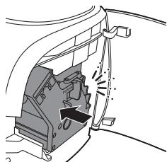
**10** Вставте блок заварювання в машину вздовж бокових напрямних рейок до фіксації.
