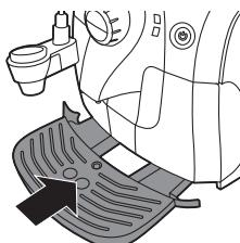
5 Удалите защитную наклейку с поддона для капель, вставьте поддон в направляющие пазы на передней панели кофемашины и задвиньте его.
