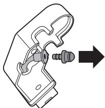
5 Снимите трубку со штуцером.
