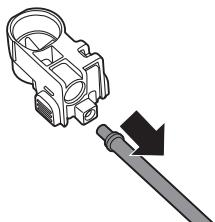
6 Снимите штуцер с трубы.
