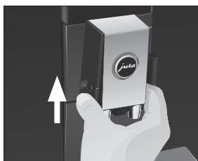
► Монтируйте комбинированный дозатор на кофемашину. Вы услышите щелчок при его фиксации.
