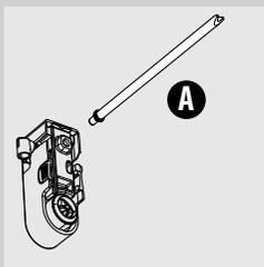
**4** Снимите всасывающую трубку со штуцером (А) со вспенивателя молока.
