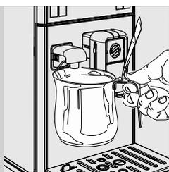
**9** Вставьте емкость под устройство подачи горячей воды.
