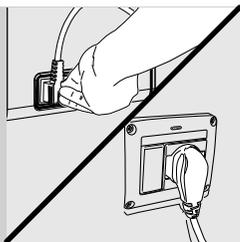
**11** Вставьте штепсельную вилку в розетку, расположенную в задней части машины.
