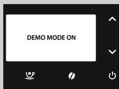
Машина оснащена программой имитации работы. Удерживая нажатой кнопку «
