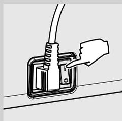
**13** Установите главный выключатель, расположенный сзади, в положение «I», чтобы включить машину.
