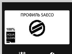
**12** По окончании подачи уберите и опорожните емкость. На дисплее машины появится изображение, приведенное сбоку. Иконка показывает ресурс только что установленного фильтра AQUACLEAN. На экране готовой машины появиться иконка «AquaClean 100%», чтобы указать на то, что фильтр был активирован.
