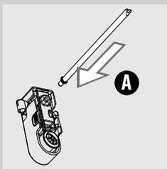
**14** Вставьте всасывающую трубку со штуцером (A) в вспениватель молока.
