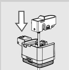
**6** После установки всасывающей трубки со штуцером, вставьте устройство подачи графина в верхнюю часть графина.
