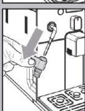
**i** После вспенивания молочных напитков подайте горячую воду из трубы выдачи пара/горячей воды (насадки Pannarello, если входит в комплект), чтобы обеспечить полную очистку.
