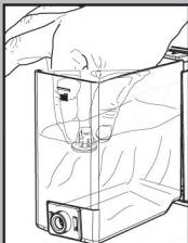
Извлеките фильтр для воды из упаковки, погрузите вертикально (с отверстиями, направленными вверх) в холодную воду и слегка придайте его стороны, чтобы удалить пузырьки воздуха.
