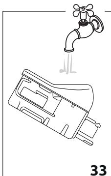
6. Ополосните гнездо для регулятора пены под проточной водой (см. рис. 33).
