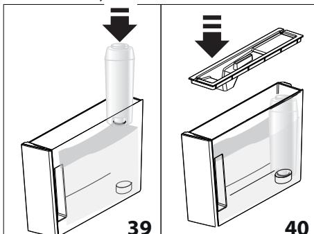
После установки фильтра следует сообщить о его наличии прибору.
