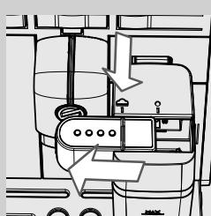
**3** Вставьте графин в машину. Извлеките устройство подачи графина влево до отметки «».
