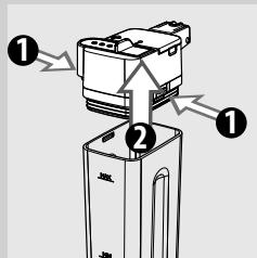
**1** Нажмите разъединяющие кнопки, чтобы снять верхнюю часть графина.
