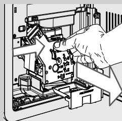
**10** Снимите контейнер для сбора отходов и откройте дверцу для обслуживания. Снимите контейнер для сбора жидких отходов и блок приготовления кофе.
