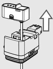
**3** Поднимите устройство подачи, чтобы вынуть его из верхней части графина. Устройство подачи графина для молока состоит из пяти частей, которые необходимо демонтировать. Каждая часть обозначена прописной буквой (A, B, C, D, E), как показано на рисунках ниже.
