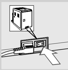
**7** Установите главный выключатель, расположенный сзади машины, на «0».
