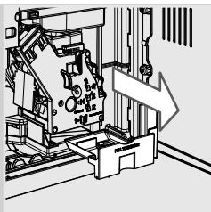
**2** Опорожните и вымойте контейнер для сбора жидких отходов, расположенный внутри машины. Откройте дверцу для обслуживания, достаньте контейнер и опорожните его.
