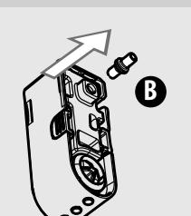
**5** Снимите штуцер (B) со вспенивателя молока, потянув его наружу.
