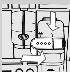
**10** Вставьте устройство подачи графина на место, перемещая его до отметки «●».
