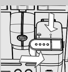
**10** Вставьте устройство подачи графина на место, перемещая его до отметки «●».
