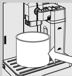
**13** Вставьте графин для молока в машину. Извлеките устройство подачи графина влево до отметки «▲». Поместите емкость под устройство, чтобы запустить цикл ополаскивания.
