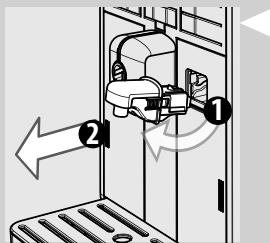
**1** Если установлено устройство подачи воды, снимите его, как показано на рисунке:
