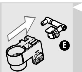
**8** Снимите штуцер (E) со вспенивателя молока, потянув его наружу.
