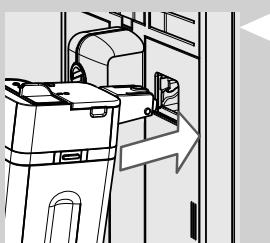
**2** Слегка наклоните графин для молока. Полностью вставьте его в направляющие машины.
