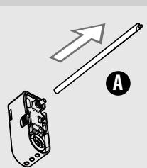
**4** Снимите всасывающую трубку (A).
