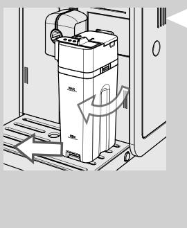
**1** Поверните графин вверх до его естественного отсоединения от вставки, расположенной в поддоне для сбора капель. Затем снимите его.
