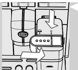
**10** Вставьте устройство подачи графина на место, перемещая его до отметки «●». Снимите графин для молока и опорожните его.
