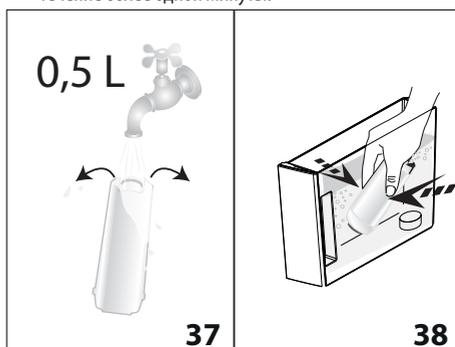
4. Достаньте бачок (A18) из машины и заполните его водой.
