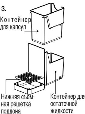
4. В случае необходимости, можно снять контейнер для остаточной воды. Для этого, отделите его от нижней части поддона (защелкивающий замок).
